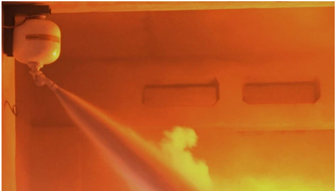
Сурет 1.13 - Ұнтақты өрт сөндірудің автономды моделі
